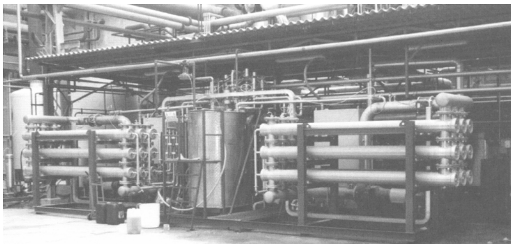
شکل ۲- یک واحد که از تکنولوژی غشایی بهره‌گیری می‌کند. واحدهای غشاهای مدور قابل رویت می‌باشند.
