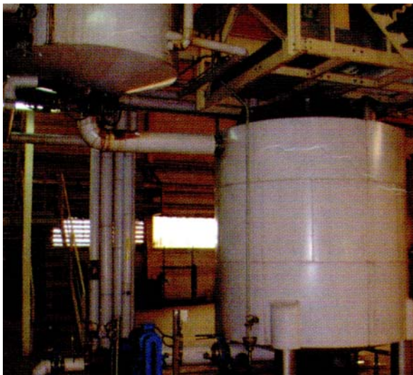
شکل ۵: کریستالیزور سرمایشی با مخزن دریافت‌کننده و پمپ سیرکولاسیون
