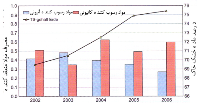
شکل ۱۰: ماده خشک و مصرف مواد منعقد کننده در بی آب کردن کل چغندرها
