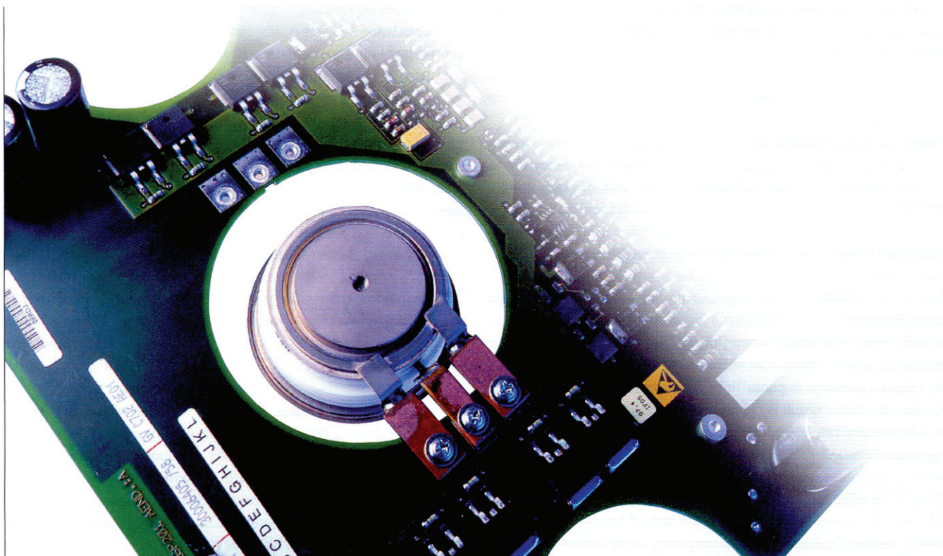
شکل ۴: مدول IGCT با دیود هد ایت کنند ه معکوس یکپارچه و واحد دروازه برای ACS۱۰۰۰
