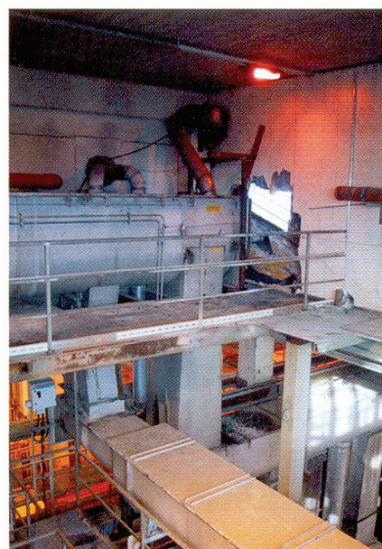
شکل ۶: برای تعمیر، هلیس از طریق ایجاد یک سوراخ در دیوار به خارج انتقال یافت
