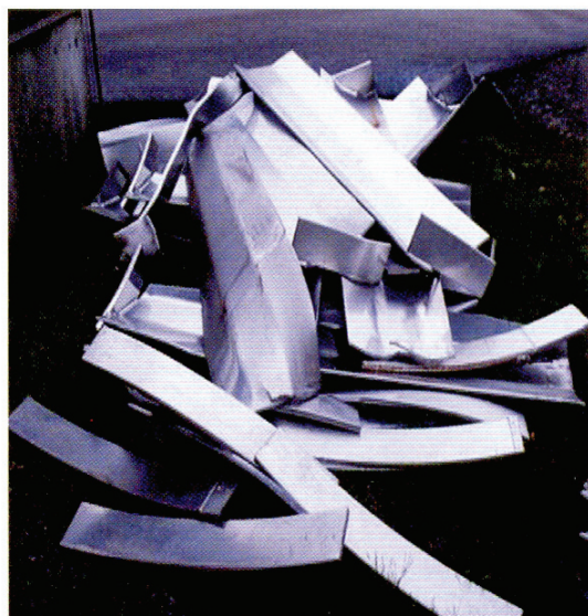
شکل ۷: بخش فوقانی صدمه دیده یک برج دیفیوزیون در کارخانه Örtöfta
