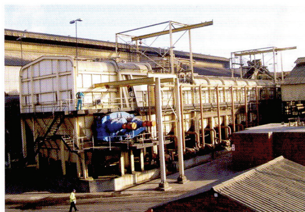
شکل ۵: دیفوزور با ظرفیت ۳۰۰ تن نیشکر در ساعت در کارخانه Maidstone
