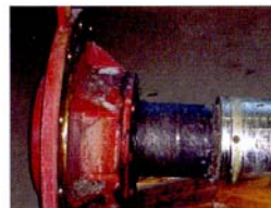
شکل ۷: اکسن فورت: پرید گی توبی محور مایسه (چپ) شکل ۸: اکسن فورت: پرید گی توبی محور مایسه: نمای جلو (راست)
