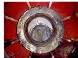
شکل ۹: آکسن فورت: پریدگی توپی محور، شکستن توپی و به طرف پایین تست کردن محور مایشه
