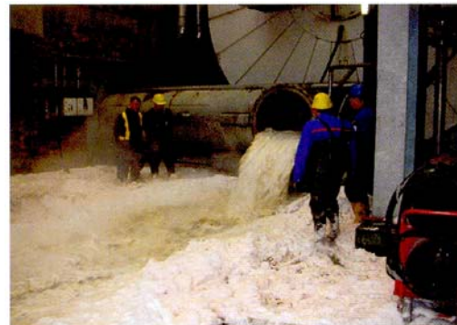
شکل ۱: اکسن فورت: تستشوی خلالها بعد از شکستن توبی محور مایسه خلال
