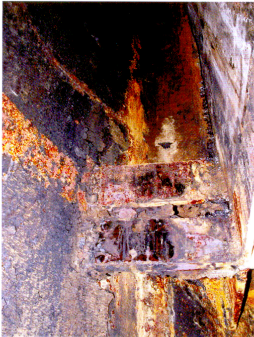
شکل ۶: لایه شکر سوخته در کانال های بالا رونده داخلی
